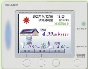
シャープ カラー電力モニター
